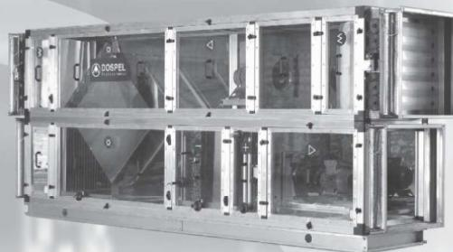
Centrale w wykonaniu wewnętrzny przeznaczone są do pracy wewnętrz budynków, w pomieszczeniach takich jak: wentylatorownie, piwnice itp. Obudowy centralne wykonane są z płyt warstwowych wypełnionych sztywną pianką poliuretanową lub wełną mineralną, obustronnie pokrytych blachą ocynkowaną. Płyty warstwowe stanowią doskonałą izolację termiczną spełniającą rygorystyczne wymagania akustyczne.
