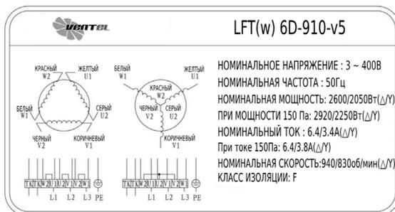
Рис. 2 - Схема подключения
