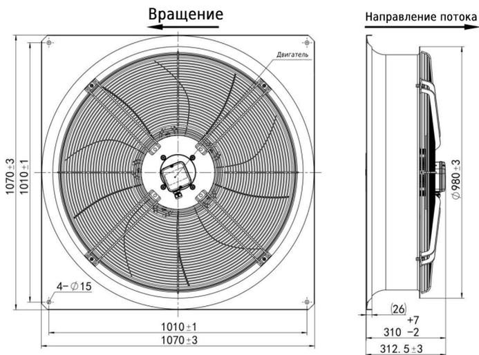
Рис. 1 - Габаритные размеры вентилятора
