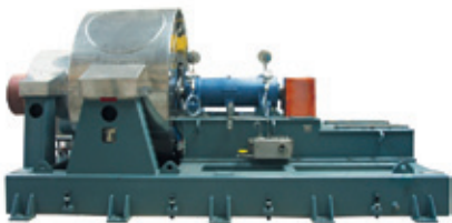
Регенерационный вентилятор для процесса CCR со смазкой масляным туманом
