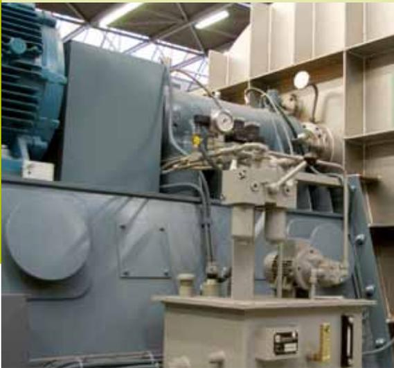
Опорная система Piller-Quetschöldämpfung с агрегатом маслоснабжения подшипников
