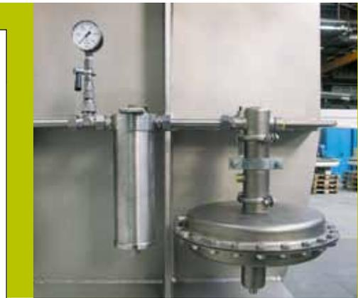
Запирающая среда блок регулировки и фильтрации пара
