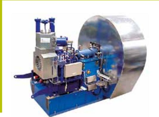
Компрессор с приводом паровой турбины для промышленного производства сока из фруктов и овощей
