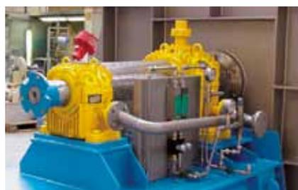
Опорный узел (с подшипником скольжения) с системой Piller-Quetschöldämpfung
