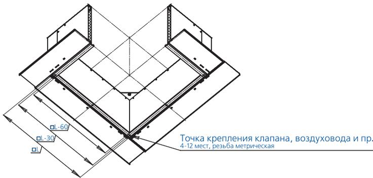
**Габаритные и присоединительные размеры с пластинами шумоглушения**
